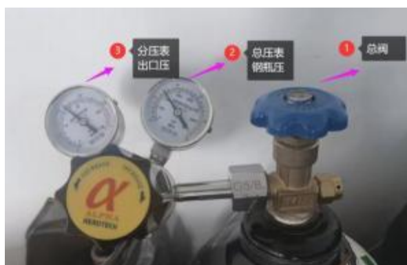
1.总压阀 2.总压表 3.分压表 0.4MPA
