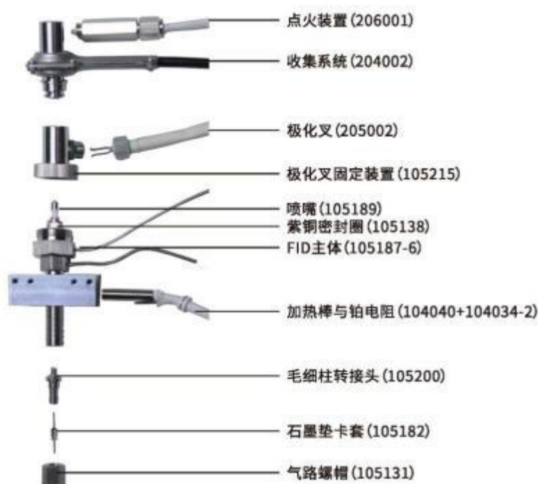
图 1.8 氢火焰离子化检测器（FID）结构图
