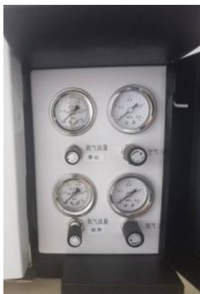
图 7 Plus 型色谱仪：柱前压及氢气空气
