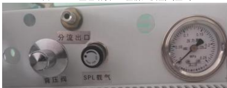
图 8 为 SmartPlus 型色谱仪：载气表区域 背压阀：调节柱前压，SPL 载气：调节总流量（分流流量）
